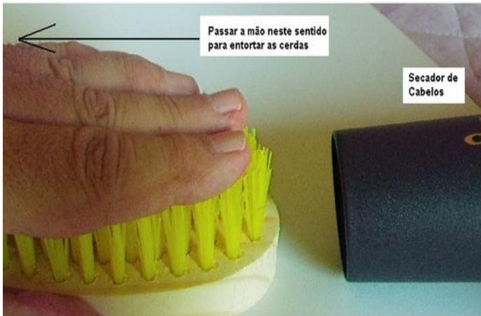
*Figura 10 – Entortando as cerdas com ar quente.*
