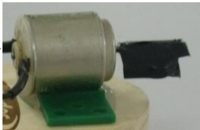
Figura 7 – Colocando o peso excêntrico no eixo.
