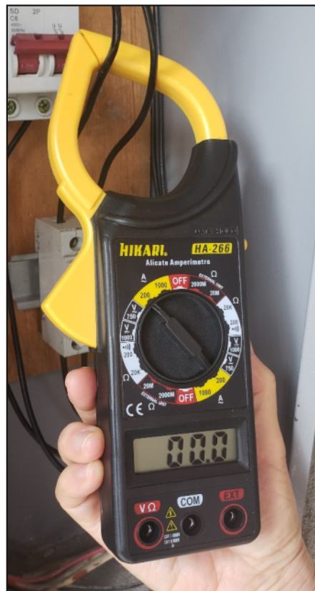
Figura 7 - Se os dois fios forem envolvidos nada é medido (00.0)
