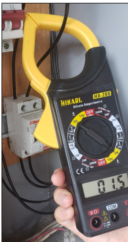
Figura 6 - Medindo o consumo de um aparelho de ar-condicionado
